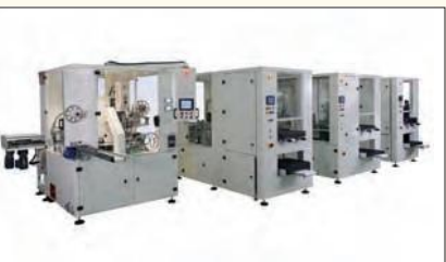
Exemples de ligne et machine d'assemblage : à gauche, intégration de systèmes d'emboitage, goupillage et soudure US avec trois palettiseurs pour l'alimentation des pièces et transfert par convoyeur - à droite machine d'assemblage robotisée avec contrôle mécanique ou optique et évacuation par tapis de tri. Au centre : cellule équipée d'un robot rotatif 6 axes.
