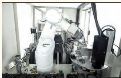
DMA intègre notamment des robots 6 axes Staubli dans ses équipements.
