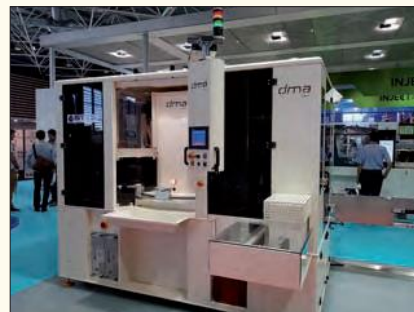
Cellule de décoration par tampographie dotée de systèmes de prétraitement plasma et de séchage infrarouge.
